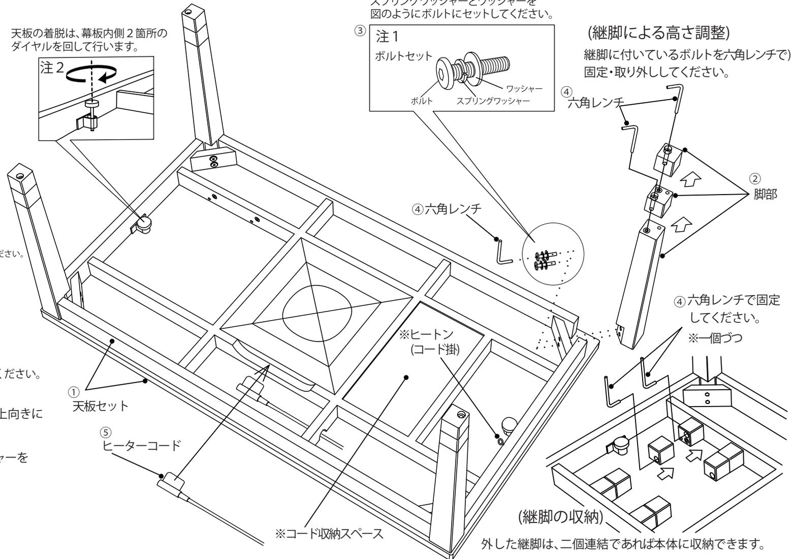
スプリングワッシャーとワッシャーを図のようにボルトにセットしてください。
