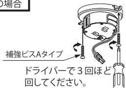
⑤本体の固定ネジを外し、シーリングプレートを取り出します。
