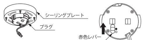
**警告** プラグの引っ掛け刃が回転防止ツメに接触している場合は赤色のレバーが動きません。必ずプラグの引っ掛け刃が完全に出た状態で赤色レバーを「●レバーロック」に合わせてください。
