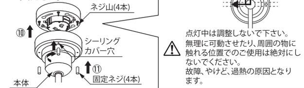
この時にネジ山をシーリングカバー穴に通す位置で角度を調整します。約90°
