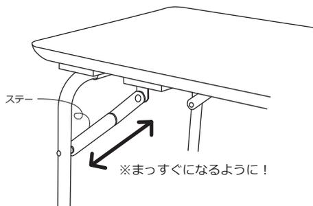
脚を閉じる時は天板を下にして床に置き、ステーを下図のように軽く折り曲げ、脚の外側からゆっくりと力をかけて脚を折りたたんでください。
