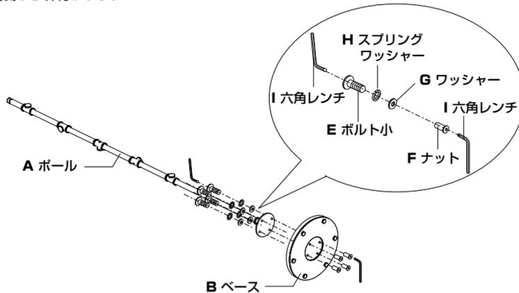
**2** **1**で組んだものを周囲に気をつけながら起こします。**C**フックを**A**ボールのパイプ口に合わせて入れ込み、反対側から**D**ボルト大に**H**スプリングワッシャーと**G**ワッシャーを通して、付属の**I**六角レンチで締付けます。
