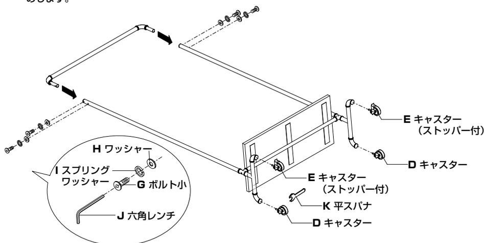
**3** 上図のように**D**キャスター、**E**キャスター (ストッパー付) を**A**サイドポールの下端にねじ込み、付属の**K**平スパナできつく締め付けます。
